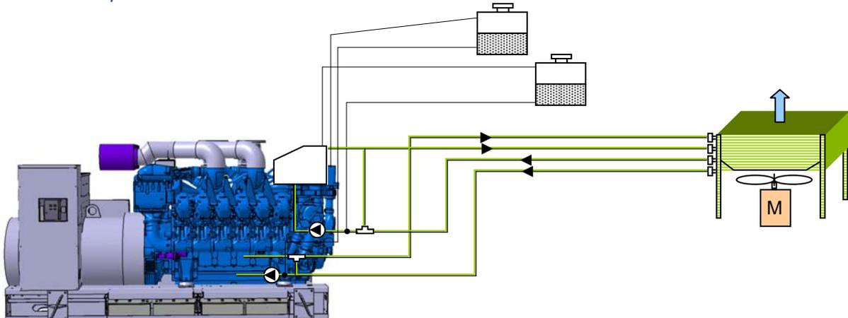
Circuit d'eau de refroidissement HT et BT
